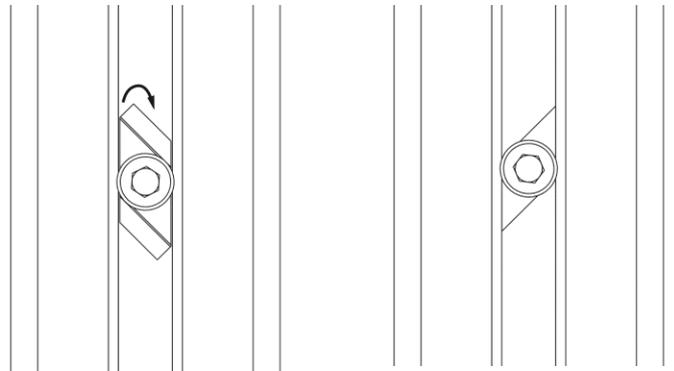
Positionieren der Rhombusmutter durch Eindrehen im Uhrzeigersinn
